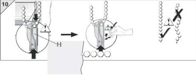
10. Τέλος βάλτε το άγκιστρο (H) στην αλυσίδα και τεντώστε μέχρι ότου φτάσει στο χαμηλότερο δυνατό σημείο, όπου η αλυσίδα θα είναι τεντωμένη. Αφαιρέστε την προστατευτική ταινία από το πίσω μέρος και κολλήστε το άγκιστρο στο σημείο αυτό. Η εγκατάσταση έχει πλέον ολοκληρωθεί.
