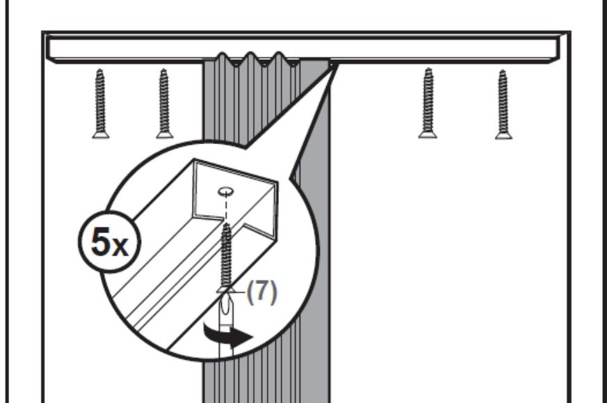
6. Τοποθετείστε στην πλαϊνή κάσα (στην πλευρά όπου η πόρτα θα είναι σταθερά στερεωμένη) τα εξαρτήματα στερέωσης (4) σύμφωνα με το παρακάτω σχήμα. Στερεώστε το ακριανό φύλλο της πόρτας ακούγοντας τον χαρακτηριστικό ήχο «κλικ».
