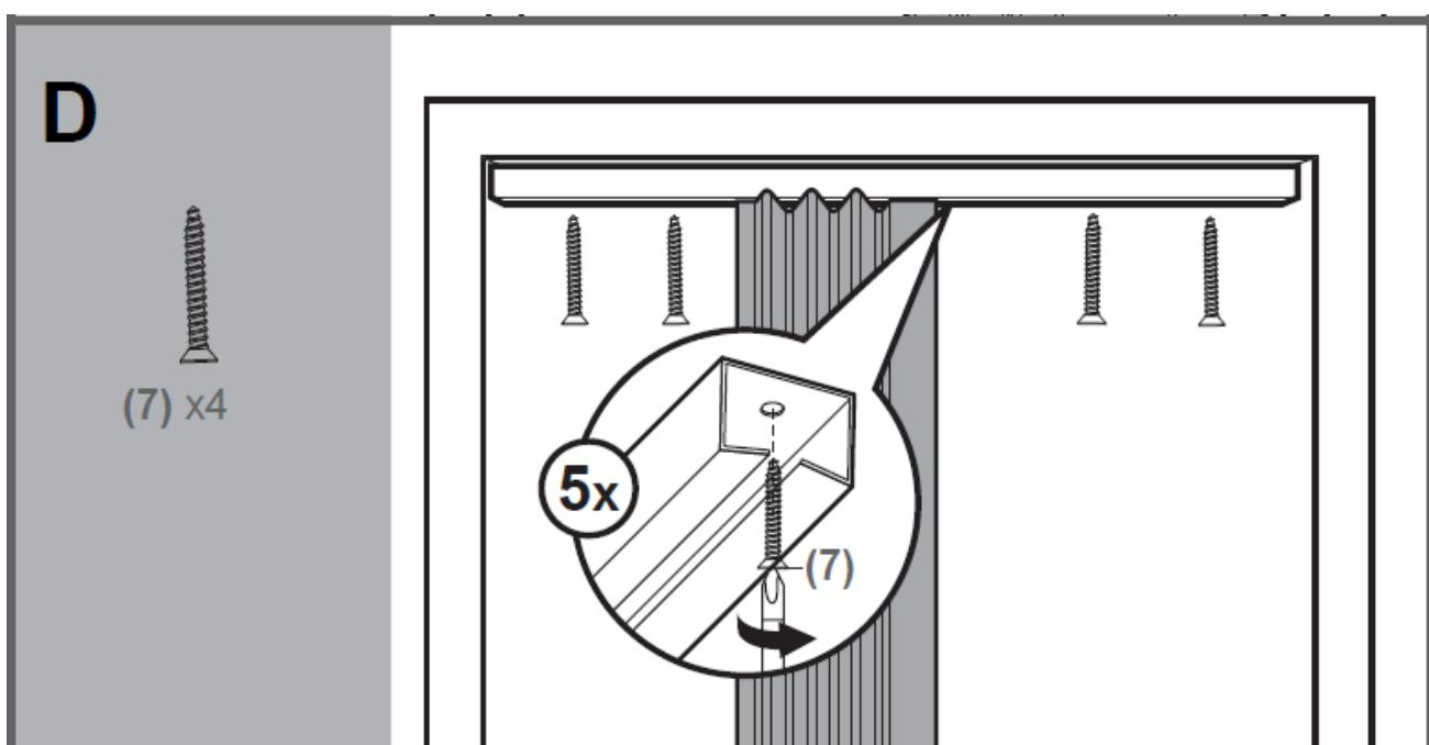
6. Τοποθετείστε στην πλαϊνή κάσα (στην πλευρά όπου η πόρτα θα είναι σταθερά στερεωμένη) τα εξαρτήματα στερέωσης (4) σύμφωνα με το παρακάτω σχήμα. Στερεώστε το ακριανό φύλλο της πόρτας ακούγοντας τον χαρακτηριστικό ήχο «κλικ».
