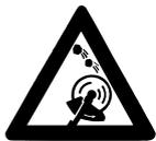
Proverite teren: tvrdi predmeti – kamenje, metalni delovi i sl. mogu biti zahvaćeni i odbaćeni čak i dalje od 15 m – **opasnost od povreda!** – i mogu oštetiti rezni alat i druge predmete (na primer, parkirana vozila, prozorska stakla) (materijalna šteta).
