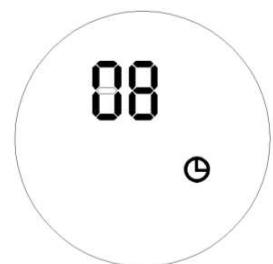
**Σημείωση:** Αν δε ρυθμίσετε τη θερμοκρασία και το εβδομαδιαίο πρόγραμμα, η συσκευή θα απενεργοποιηθεί αυτόματα μετά από 12 ώρες συνεχόμενης λειτουργίας και θα μπει σε κατάσταση αναμονής.
