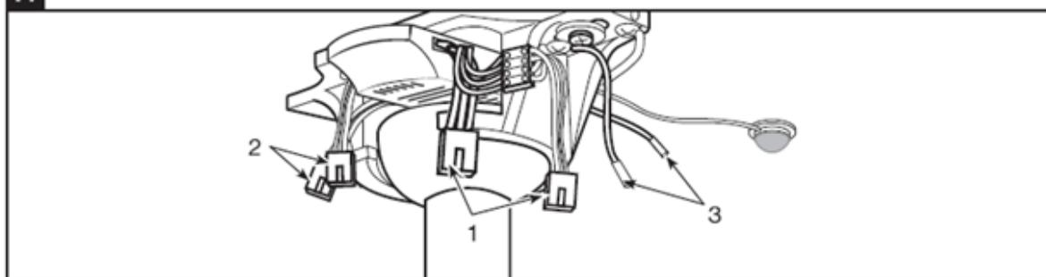
Καθώς ο ανεμιστήρας κρέμεται στην υποδοχή, συνδέστε την 4-πολική σύνδεση στη βάση της οροφής με την 4-πολική βυσματική σύνδεση του τηλεχειριστηρίου (1). Συνδέστε την 4-πολική βυσματική σύνδεση της διάταξης του δέκτη με την 4-πολική βυσματική σύνδεση του ανεμιστήρα (2). Συνδέστε το καλώδιο γείωσης (3) της ράβδου ανάρτησης με τη βάση της οροφής.
