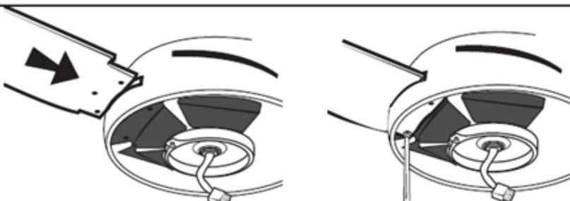
Τοποθετήστε τα πτερύγια στις οπές που υπάρχουν στο πλαίσιο του μοτέρ, σύμφωνα με το σχέδιο και σταθεροποιήστε τα στις προεγκατεστημένες υποδοχές με τις παρεχόμενες βίδες.
