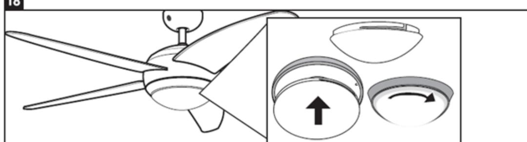
Αναζητήστε τις εγκοπές στη βάση του σωληνωτού λαμπτήρα αλογόνου και εφαρμόστε τες στις αιχμηρές ακμές που υπάρχουν στην υποδοχή της λάμπας. Ανασηκώστε το γυαλί, έτσι ώστε να εισαχθούν οι αιχμηρές ακμές στις εγκοπές που υπάρχουν στη βάση του σωληνωτού λαμπτήρα αλογόνου. Περιστρέψτε τη βάση του λαμπτήρα δεξιόστροφα, μέχρι να ασφαλίσει στη θέση της.
