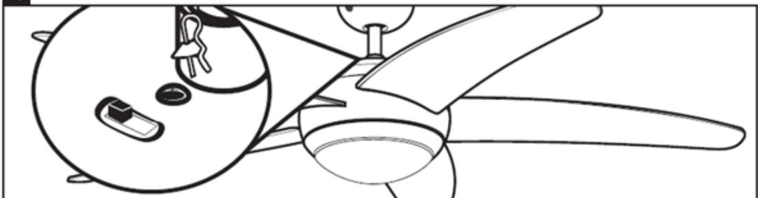
Για να αντιστρέψετε τη φορά περιστροφής των πτερυγίων του ανεμιστήρα, αθήστε το διακόπτη αντίστροφης κίνησης (βρίσκεται στο επάνω μέρος του πλαισίου του μοτέρ) στην αντίθετη θέση. Υπόδειξη: Σιγουρευτείτε πως ο διακόπτης αντιστροφής βρίσκεται σε μια από τις δυο θέσεις. Ο ανεμιστήρας δεν λειτουργεί όταν ο διακόπτης βρίσκεται σε κάποια ενδιάμεση θέση.
