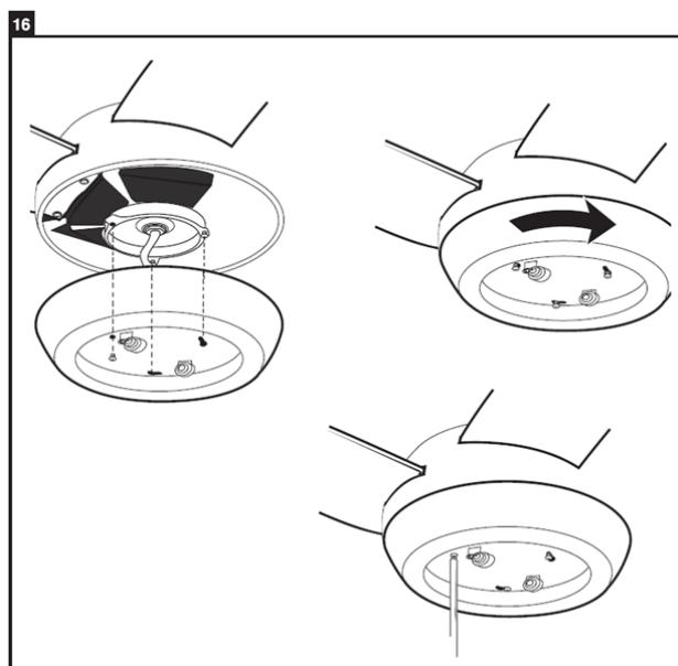
Το φωτιστικό έχει 3 εγκοπές. Ευθυγραμμίστε τις εγκοπές στο φωτιστικό με τις προεξέχουσες βίδες από την πλάκα υποστήριξης του φωτιστικού. Σηκώστε το φωτιστικό αφήνοντας τις προεξέχουσες βίδες από την πλάκα υποστήριξης να εισέρθουν στις εγκοπές του φωτιστικού. Περιστρέψτε το φωτιστικό δεξιόστροφα για να «πιαστούν» οι εγκοπές και σφίξτε τις βίδες για να ασφαλιστεί το φωτιστικό.
