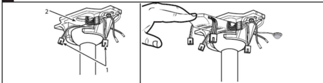
Μετά τη σταθεροποίηση του ανεμιστήρα στην οροφή, προσέχετε να μην κρέμονται οι ταχυσύνδεσμοι του ανεμιστήρα και η διάταξη σύνδεσης (1) της οροφής πάνω από τη σφαίρα ασφαλείας (2). Ωθήστε το δέκτη στο χώρο πάνω από τη σφαίρα ασφαλείας (βλ. σχήμα).
