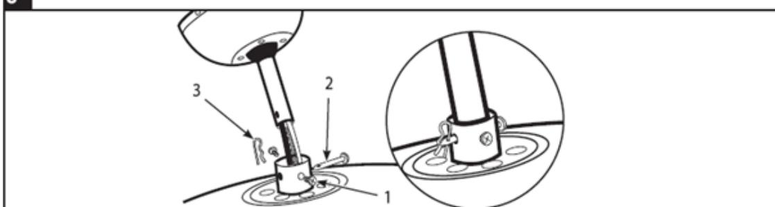
Χαλαρώστε τις βίδες ρύθμισης στη σύνδεση της ράβδου ανάρτησης (1). Εισάγετε την ράβδο ανάρτησης στη σύνδεση της ράβδου ανάρτησης. Φροντίστε να ευθυγραμμίσετε την οπή στην κάθετη ράβδο με την οπή της σύνδεσης ράβδου ανάρτησης. Τοποθετήστε τον άξονα σταυρού του ζυγού (2) διά μέσου του ζυγού και της ράβδου ανάρτησης. Εισάγετε τον άξονα σύσφιξης (3) μέσα στον άξονα σταυρού έως ότου κουμπώσει στη θέση του. Σφίξτε τις βίδες ρύθμισης (1) στη σύνδεση.
