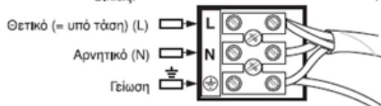
Τοποθετήστε τα καλώδια στη διάταξη σύνδεσης της οροφής, σύμφωνα με το παραπάνω σχήμα.
