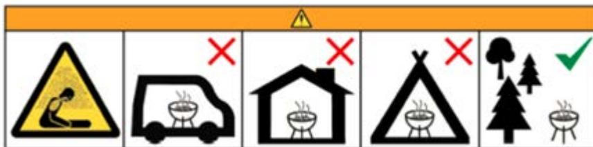
**Μη χρησιμοποιείτε την ψησταριά σε κλειστούς ή/και κατοικήσιμους χώρους όπως π.χ. σπίτια, σκηνές, τροχόσπιτα, σκάφη. Κίνδυνος θανάτου από δηλητηρίαση με μονοξείδιο του άνθρακα.**
