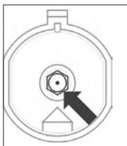
Για να αλλάξετε ένα μπεκ, ξεβιδώστε το μπεκ με ειδικό κλειδί No 7 και αλλάξτε το με καινούριο σύμφωνα με τον τύπο αερίου που χρησιμοποιείτε (δείτε τον πίνακα)
