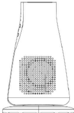
4. Στο ανω μέρος της συσκευής ευθυγραμμίστε τις 6 (έξι) βάσεις με τις αντίστοιχες τρύπες στο κάτω μέρος της συσκευής και πλησιάστε τα δύο μέρη.
