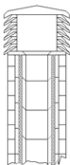
Καπέλο καπνοδόχου βιομηχανικής εγκατάστασης με αρθρωτά αντιανεμικά στοιχεία
