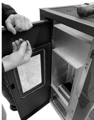
Fig. 15 - Αφαιρέστε το μεντεσέ
