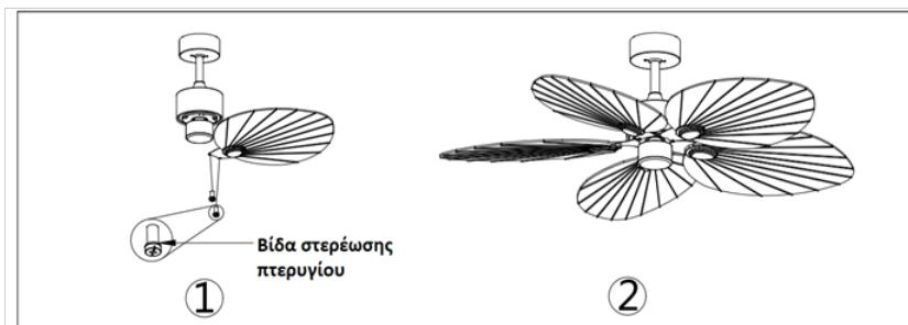
**Εξοικονόμηση χρόνου:** Οι ροδέλες για τις βίδες των πτερυγίων μπορούν να τοποθετηθούν σε κάθε βίδα του πτερυγίου πριν από την εγκατάσταση των πτερυγίων.
