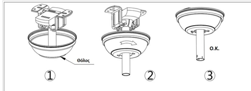
Ανυψώστε τον θόλο στη βάση στερέωσης, ευθυγραμμίζοντας τις χαλαρωμένες βίδες στη βάση στερέωσης με τις οπές στο θόλο. Στρίψτε το θόλο για να ασφαλίσει. Επανατοποθετήστε τις βίδες και ασφαλίστε όλες τις βίδες με κατασταβίδι.
