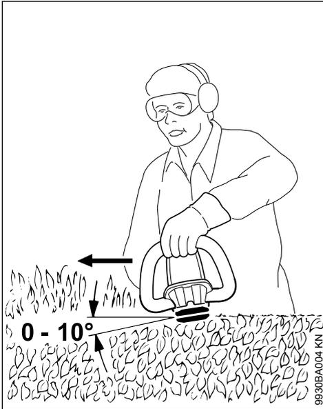
Κρατήστε το μηχανήμα έτσι, ώστε τα μαχαίρια να σχηματίζουν γωνία  $0^\circ$  έως  $10^\circ$ , αλλά κινήστε το μηχανήμα οριζόντια.
