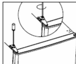
12. Τοποθετήστε το κάλυμμα του μεντεσέ και το κάλυμμα της βίδας πίσω.
