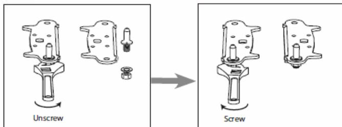
10. Επανατοποθετήστε το στήριγμα τοποθετώντας τον κάτω πείρο του μεντεσέ. Αντικαταστήστε και τα δύο ρυθμιζόμενα πόδια.
