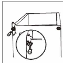
11. Τοποθετήστε ξανά την πόρτα. Βεβαιωθείτε ότι η πόρτα είναι ευθυγραμμισμένη οριζόντια και κάθετα έτσι ώστε τα σφραγίσματα να είναι κλειστά σε όλες τις πλευρές πριν σφίξετε τελικά τον επάνω μεντεσέ. Τοποθετήστε το στήριγμα μεντεσέδων και βιδώστε το στο επάνω μέρος της μονάδας. Χρησιμοποιήστε ένα κλειδί για να το σφίξετε εάν είναι απαραίτητο.
