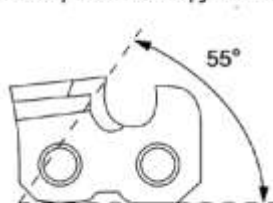
Άνω γωνία κοπής πλάκας
