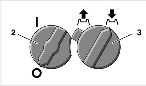
Le commutateur de sens de rotation **3** doit être mis sur la position « droite ». L'entonnoir **1** doit être vide.
