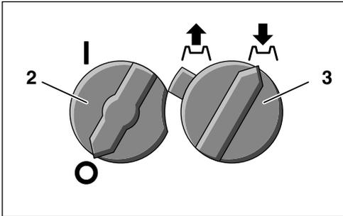
Der Drehrichtungsumschalter **3** muss in der rechten Position stehen. Der Einfülltrichter **1** muss leer sein.
