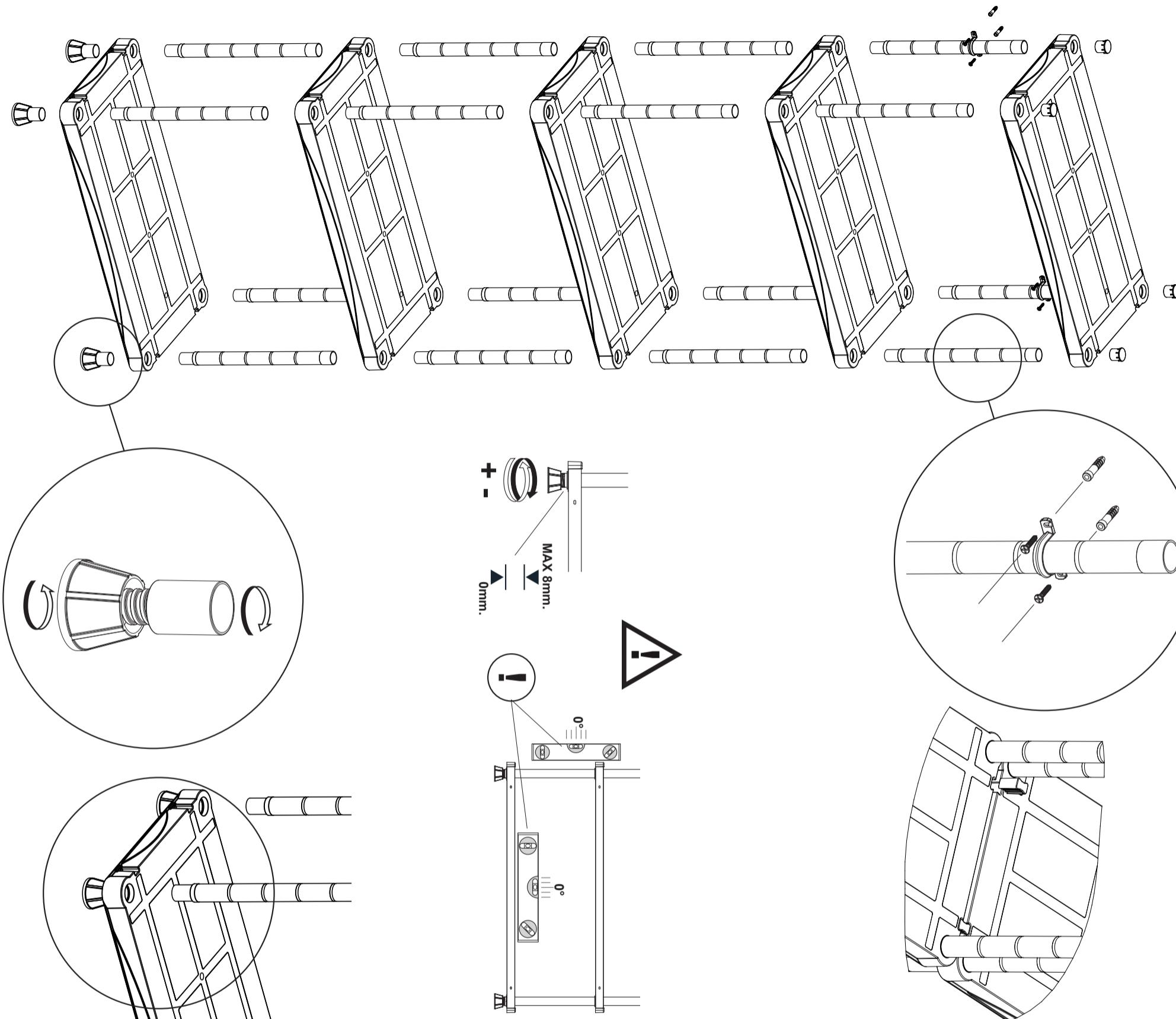
Portata massima con peso uniformemente distribuito e con scaffale fissato alla parete come indicato nelle istruzioni. Per il fissaggio alla parete utilizzare tasselli adatti al tipo di supporto/muro a cui viene fissato lo scaffale e di portata adeguata al carico posizionato sullo scaffale.
