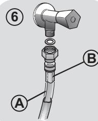
**AQUAPROTECT - PROTECȚIE SUPLIMENTARĂ FURTUN (fig. 6):** Dacă apar surgeri de apă din furtunul principal "A", învelișul transparent "B" va colecta apa scursă pentru a putea face posibilă completarea programului de spălare. La sfârșitul programului, contactați centrul de service pentru a înlocui furtunul spart.
