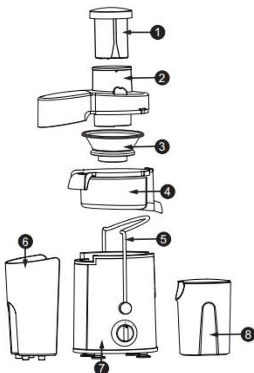
1. Πιεστήρας 2. Διαφανές κάλυμμα 3. Φίλτρο αποχύμωσης 4. Βάση φίλτρου 5. Κλιπ συγκράτησης-ασφαλείας 6. Δοχείο υπολειμμάτων 7. Κύριο σώμα συσκευής 8. Δοχείο συλλογής χυμού
