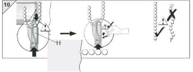
10. Τέλος βάλτε το άγκιστρο (H) στην αλυσίδα και τεντώστε μέχρι ότου φτάσει στο χαμηλότερο δυνατό σημείο, όπου η αλυσίδα θα είναι τεντωμένη. Αφαιρέστε την προστατευτική ταινία από το πίσω μέρος και κολλήστε το άγκιστρο στο σημείο αυτό. Η εγκατάσταση έχει πλέον ολοκληρωθεί.
